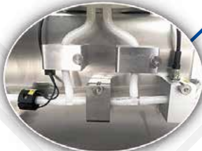
一次性流路 带空气传感器, 夹紧阀和压力传感器
