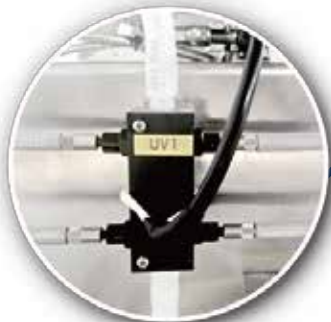
一次性流通池 具有UV, pH和电导率传感器
